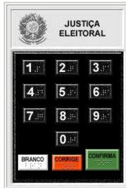
Figure 10. Clavier numérique avec inscriptions en Braille (Urne Électronique Brésilienne)
