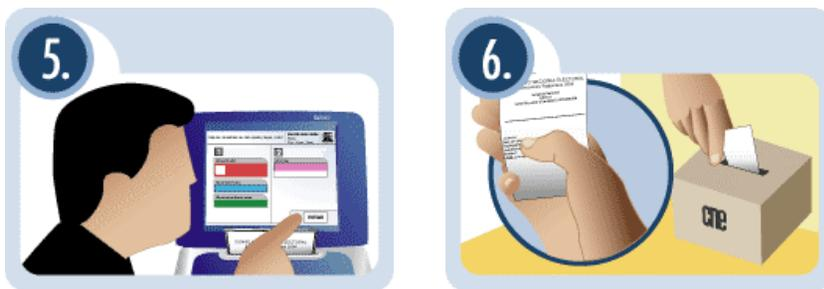
**Figure 17.** *Système Smartic, employé au Venezuela, qui imprime un bulletin en papier que l'utilisateur peut vérifier avant de le déposer dans l'urne en carton*
